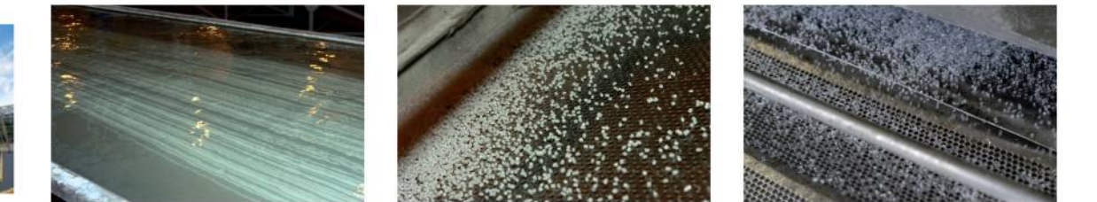
TANQUE DE RESFRIAMENTO DOS FILAMENTOS DA RESINA WATER TANK FOR COOLING
