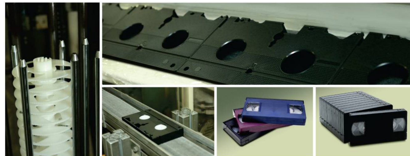
O cartucho V-0 é composto de 34 peças: montagem minuciosa. The V-0 cartridge is composed of 34 pieces: thorough assembly.
