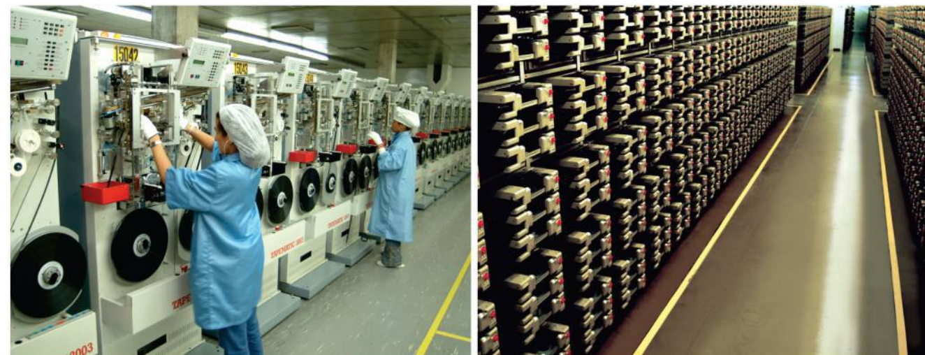
Máquinas Otari (Japão) bobinam a fita magnética VHS (1/2 polegada) nos cartuchos V-0. Otari machines (Japan) load the VHS (1/2 inch) magnetic tape into V-0 cartridges. Duplicadoras de fitas VHS (escravos): gravam em tempo real, na mesma duração do filme. VHS tapes duplicators (slaves): record in real time, the same duration of the film.
