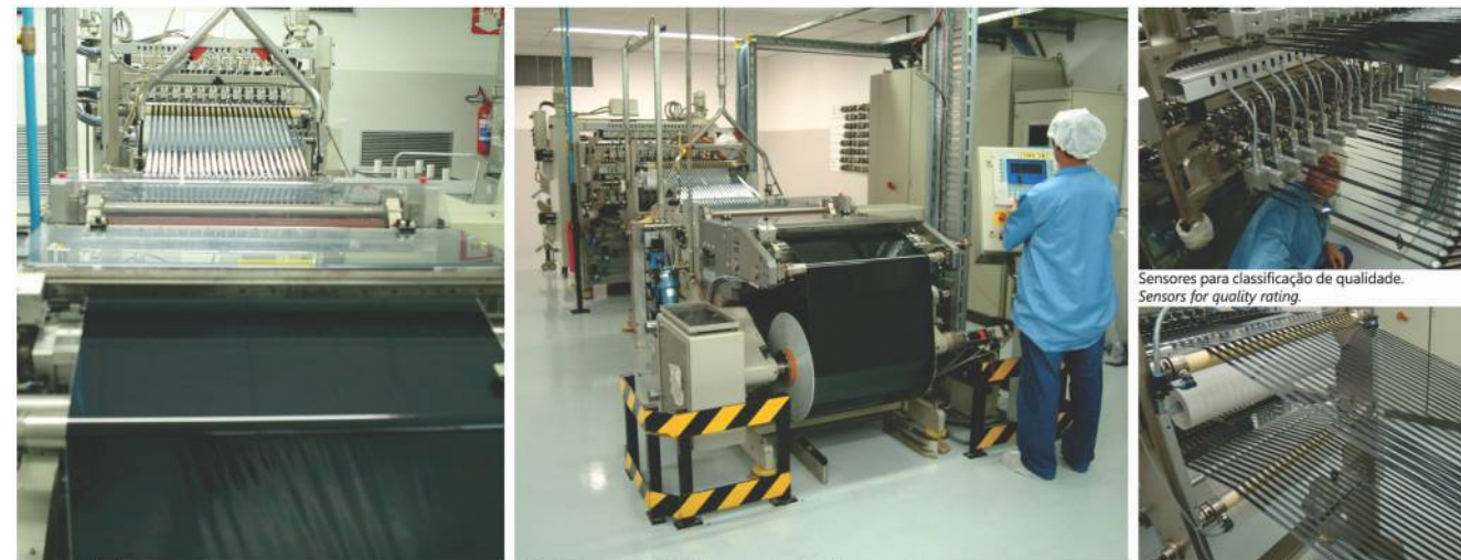
Bobina jumbo de fita magnética: processo de corte. Jumbo magnetic tape reel: cutting process. 01 bobina jumbo = 192 bobinas pancake (fita de 1/2 polegada). 01 jumbo reel = 192 pancake reels (1/2 inch tape). Tiras de fitas magnéticas VHS. VHS magnetic tape strips. Sensores para classificação de qualidade. Sensors for quality rating.
