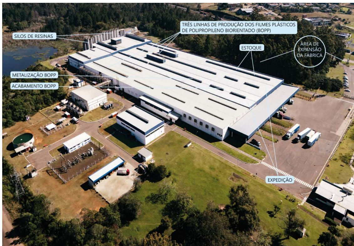
Polo Films, Montenegro (RS), Unidade III: filmes de polipropileno biorientado (BOPP).
